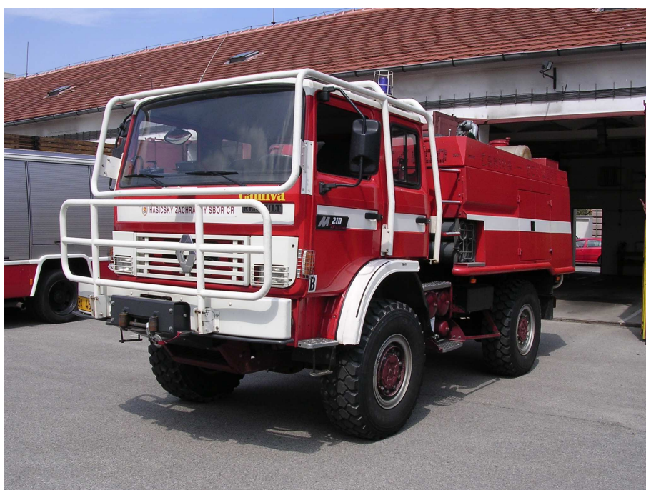
Obr.č. 12: Cisternová automobilová stříkačka terénní CAS CAMIVA
