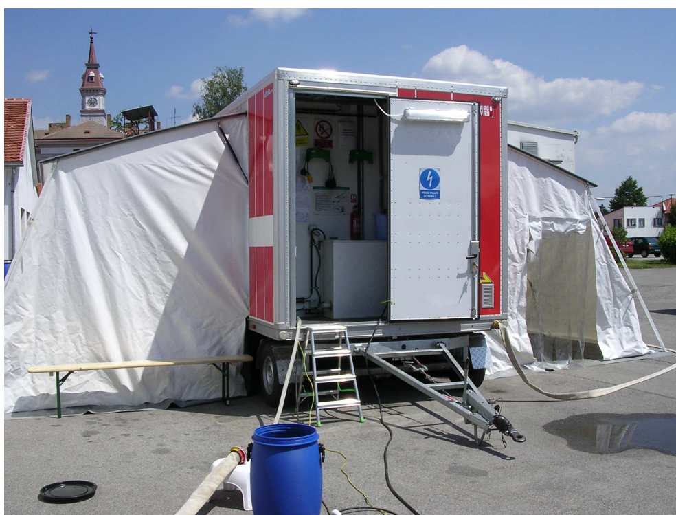
Obr.č. 10: Přívěs pro hromadnou dekontaminaci osob.
