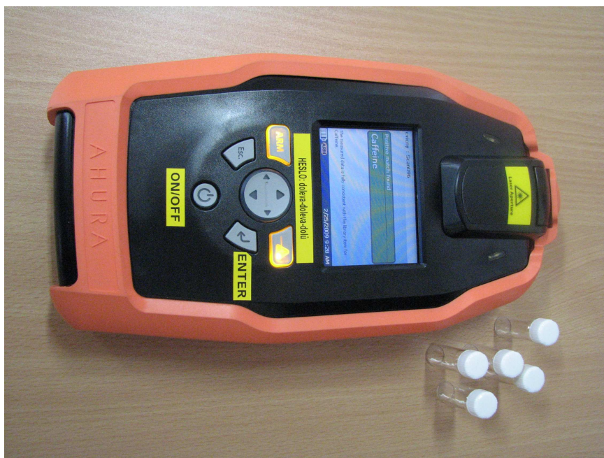
Obr. č 4.: Ramanův spektrometr First Defender .
