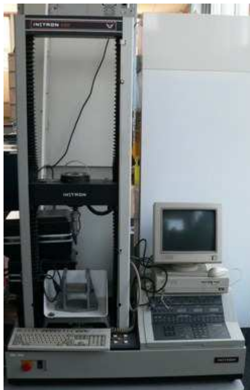
Obrázek 13 – Příklad pro tahovou zkoušku – Instron 4301
