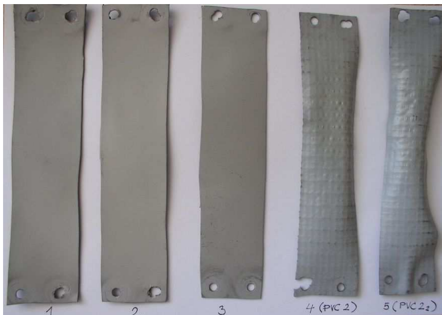
Obrázek 16 – Vzhled vzorků sady 2 po expozici v xenotestu
