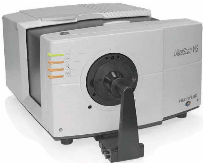
Obrázek 12 – Laboratorní spektrofotometr Hunter Lab pro měření barevnosti
