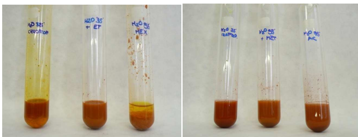
Obr. 17. Extrakce při použití vodní lázně 35° C (vzorek + voda + rozpouštědlo)
