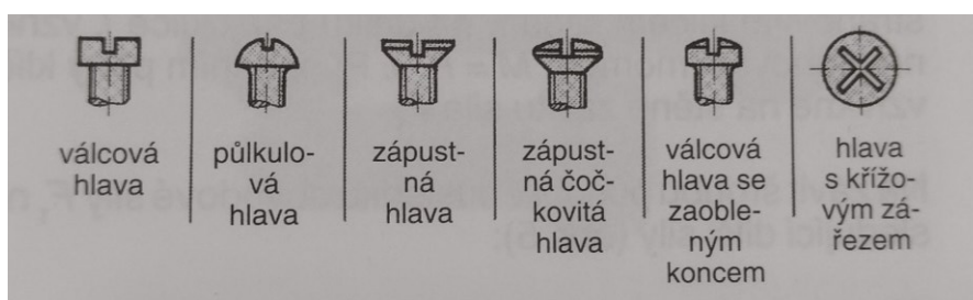
Obrázek 8 Tvary hlav šroubů se zářezem (Frischherz, Skop, Knourek 2004)
