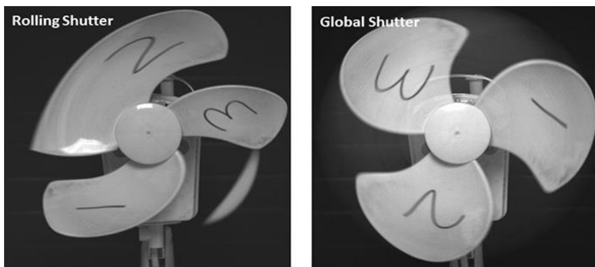
Obrázek 28, Rolling Shutter vs Global Shutter, Dostupné z: andor.oxinst.com
