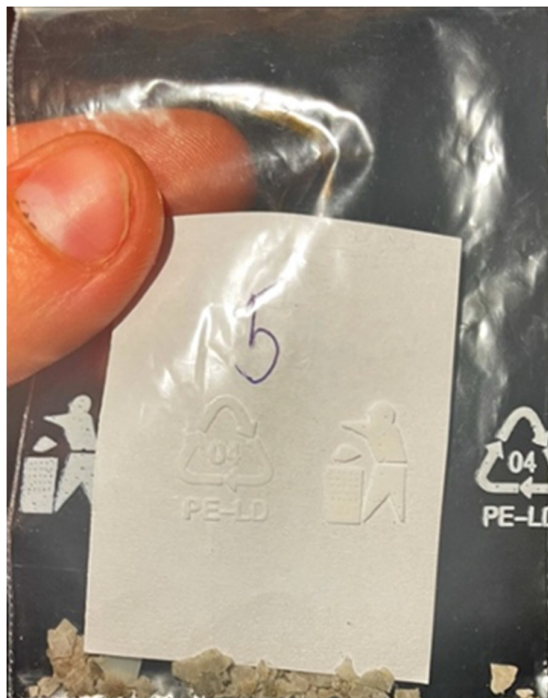
Obrázek 8: Fólie PBSA po pěti týdnech biodegradace.
