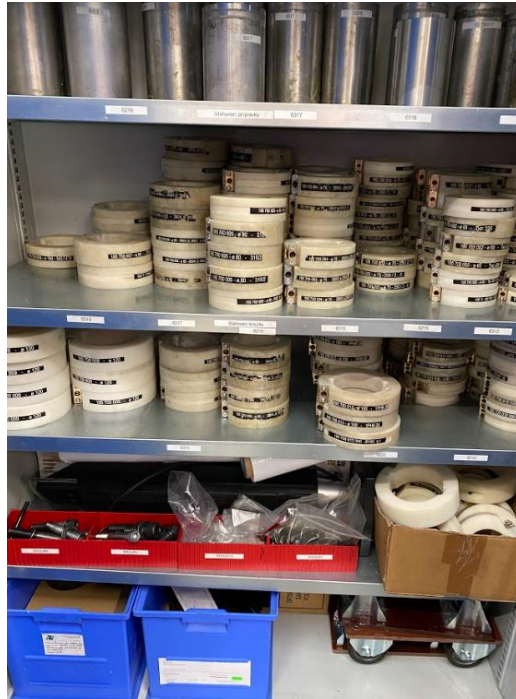
Obrázek 22 Uspořádání axiálních a radiálních upínacích přípravků podle 5S (vlastní fotografie)
