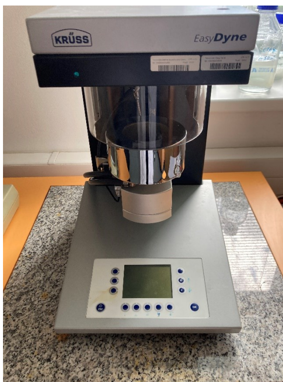
Obrázek 15: Tenziometr EasyDyne – Krüss
