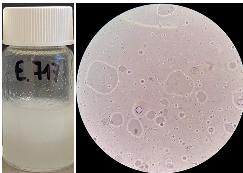
Obrázek 10: Vzorek a struktura emulze připravené z 717 ( Lb. sakei ) (400x).
