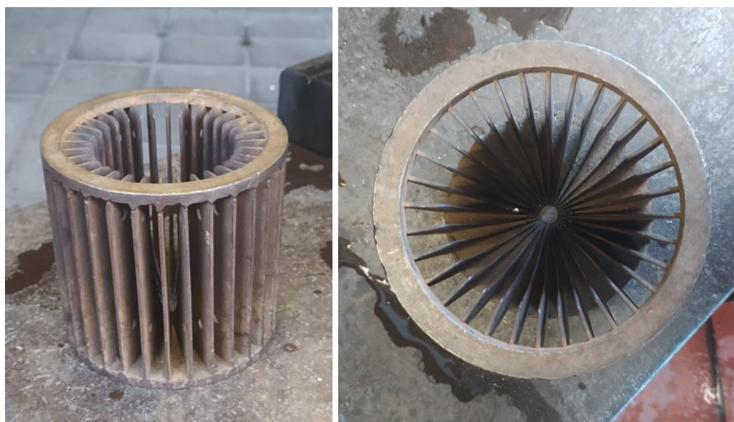
Obr. 79. Forma optiška použitá pro vzhledovou úpravu foukaných difuzorů
