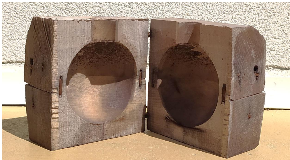
Obr. 78. Použitá vlastní forma pro foukání skla
