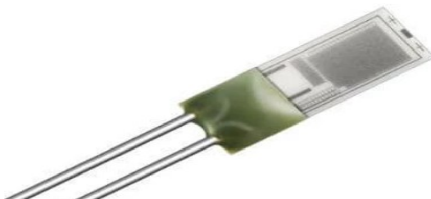
Obrázek 16 Zvětšené foto teplotního senzoru (interní dokumenty IST)
