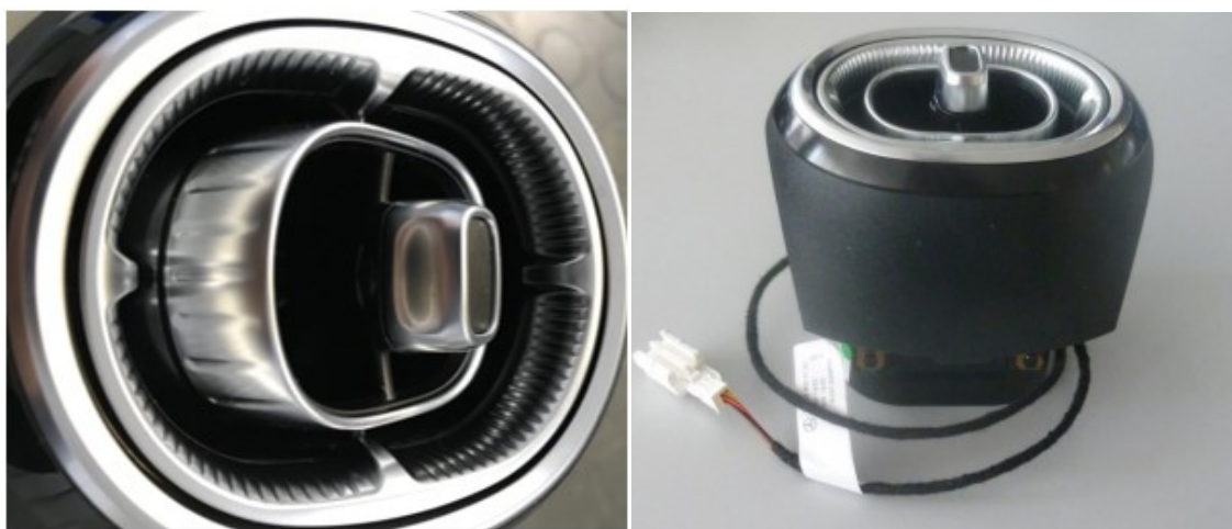
Obrázek 16 – Výdech klimatizace, konečný výrobek linky XY - Düse Mitte 1, kabelová varianta (interní zdroj společnosti)
