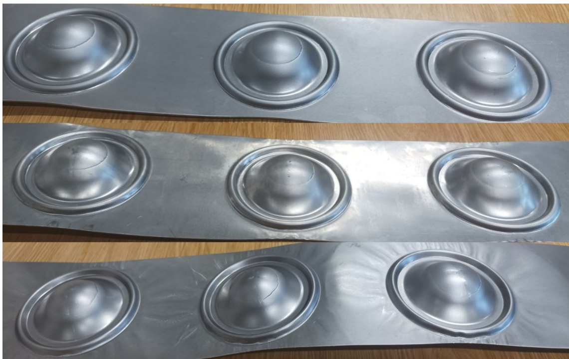
Obr. 47. Vytažené vzorky materiálu DC03 Shora plech 1,5 mm, plech 1,0 mm a plech 0,5 mm
