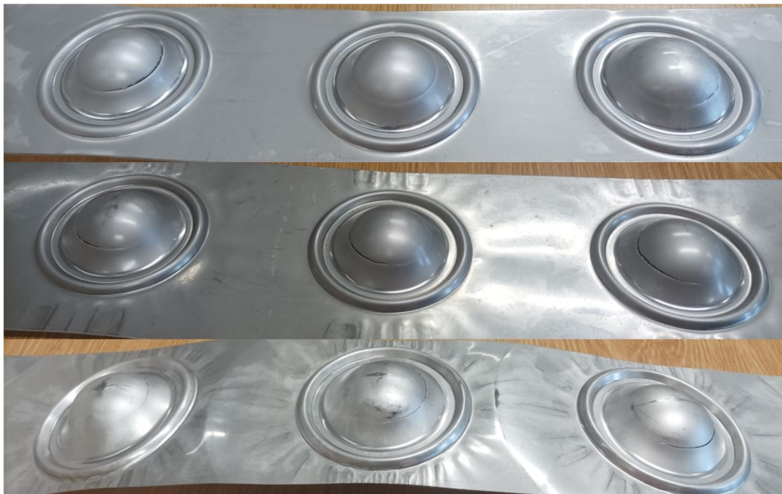
Obr. 48. Vytažené vzorky materiálu EN 1.4306 Shora plech 1,5 mm, plech 1,0 mm a plech 0,5 mm
