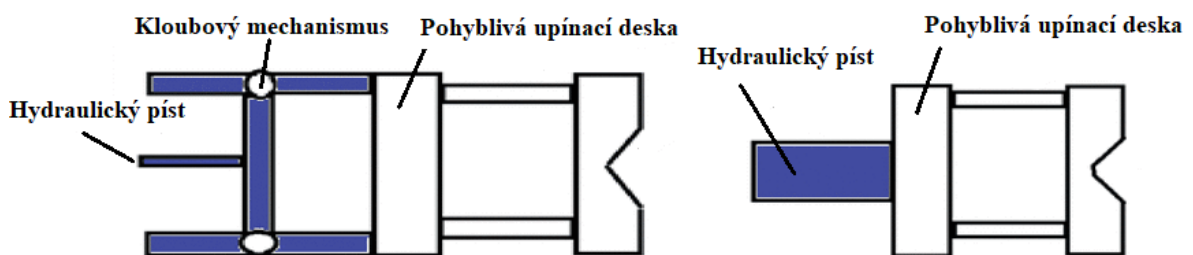
Obrázek 10 – Kloubový uzavírací mechanismus s hydraulickým pohonem (vlevo) a hydraulický uzavírací mechanismus (vpravo) [20]
