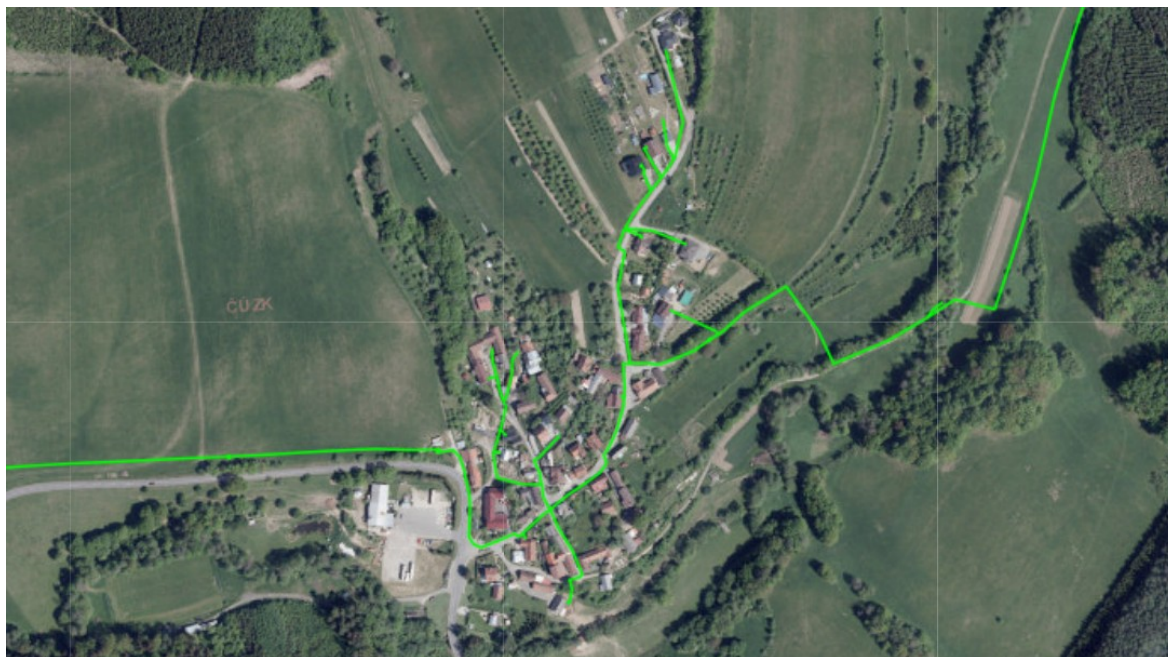
Obrázek 6 Vodovodní síť Mirošov (Projekt Valašské Klobouky, 2023)
