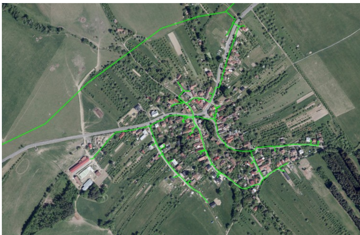
Obrázek 7 Vodovodní síť Lipina (Projekt Valašské Klobouky, 2023)
