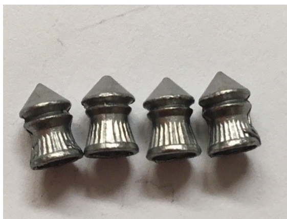
Obr. 6.5.1: Střely Magnum: vpravo dvě nevystřelené, vlevo dvě vystřelené.
