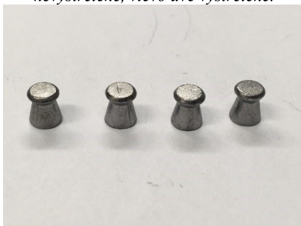
Obr. 6.5.2: Střely Pro Match: vpravo dvě nevystřelené, vlevo dvě vystřelené.
