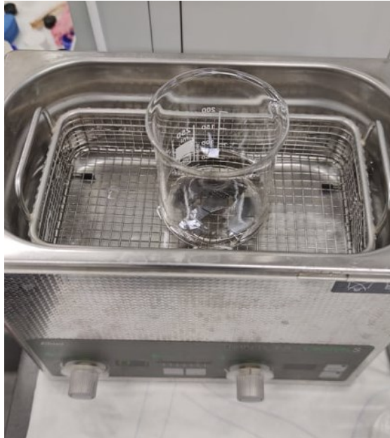
Obrázek 27 Čištění křemíkových destiček v ultrazvukové čističce pomocí acetonu
