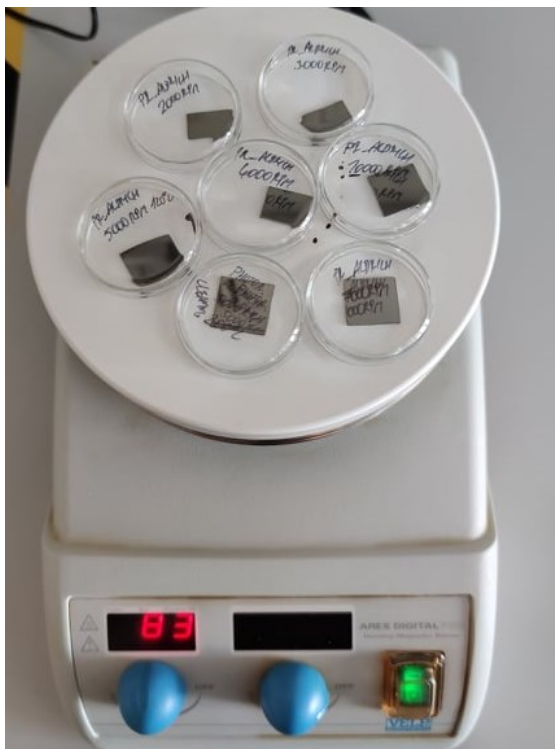
Obrázek 28 Krok softbake po rotačním nanášení polymerní vrstvy Sigma Aldrich na křemíkové substráty
