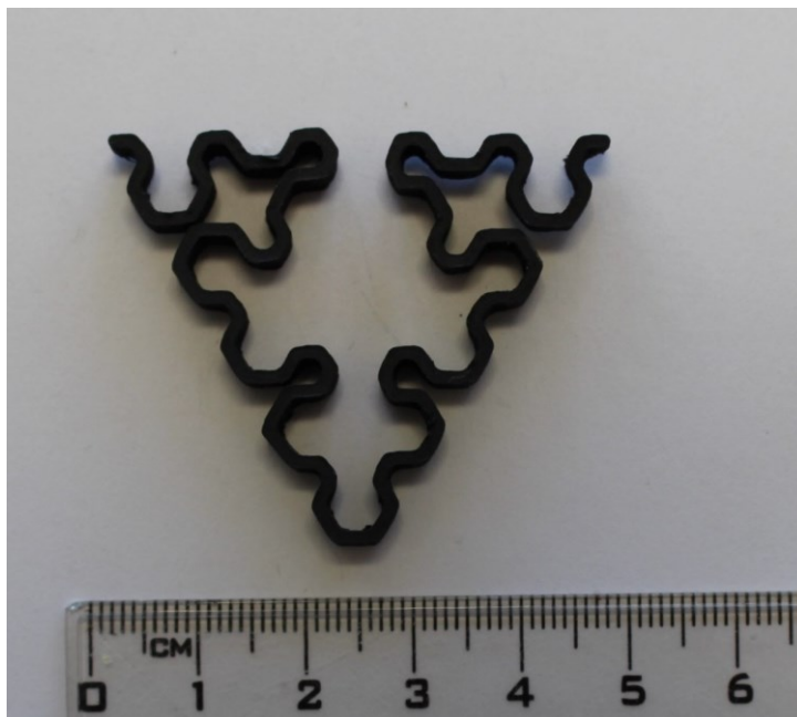
Obrázek 44 ABS Anténa č. 4, fraktál Sierpiňského křivka – 4 iterace
