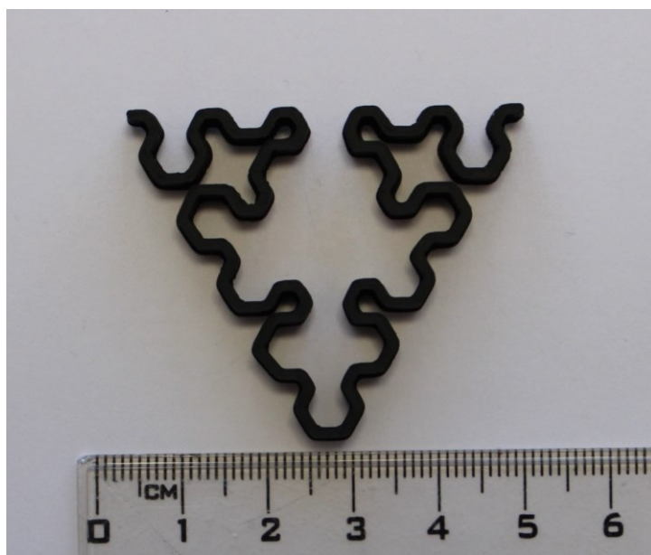
Obrázek 45 PLA Anténa č. 4, fraktál Sierpiňského křivka – 4 iterace
