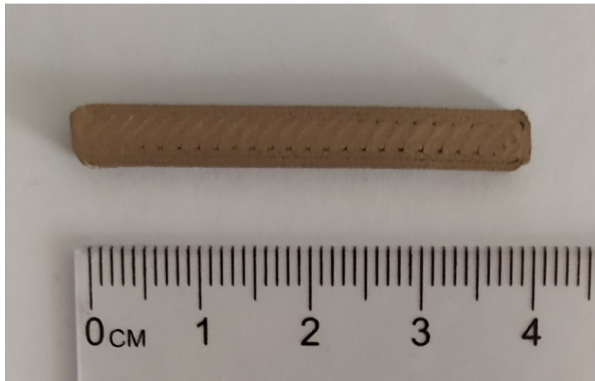
Obrázek 38 Electrifi Anténa č. 2, Unipól 40 mm
