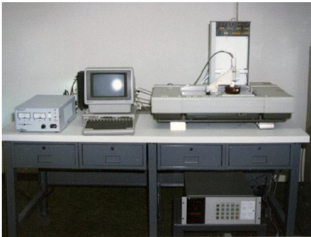
Obrázek 2 První patentovaná 3D tiskárna fungující na principu SLA [84]
