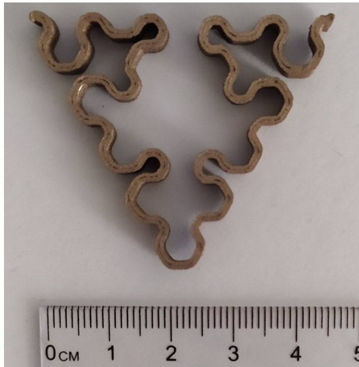
Obrázek 46 Electrifi Anténa č. 4, fraktál Sierpiňského křivka – 4 iterace
