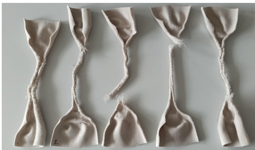
Obrázok 26 Vzorky 1 po skúške na trhacom prístroji v smere stĺpika
