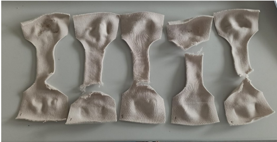
Obrázok 27 Vzorky 1 po skúške na trhacom prístroji v smere riadka
