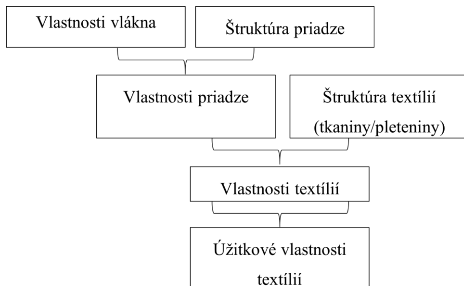
Obrázok 5 Schéma – vzťah medzi vláknom, priadzou a textíliou (Šerfőzöová, 1984)
