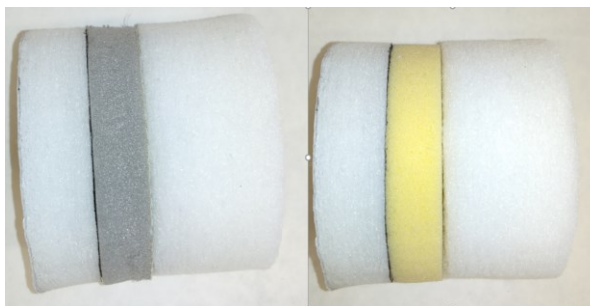
Obrázek 29: Sendviče pro měření vzduchové neprůzvučnosti vlevo sendvič s pěnou Wulfmeyer, vpravo sendvič s pěnou Molitan
