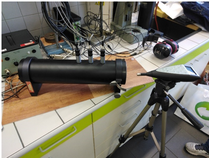
Obrázek 19: Aparatura pro měření vzduchové neprůzvučnosti
