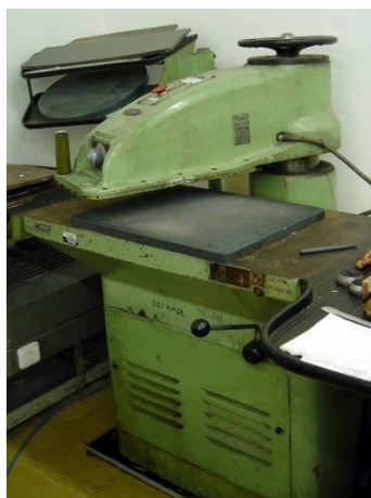
Obrázek 15: Hydraulický vysekávací stroj ZPS 06102 P1 pro vysekávání vzorků dle tvarových nožů 100 a 30 mm [15]
