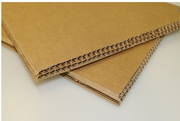
Obrázek 33: Pokus o ručně zpracované zkosení hran desek
