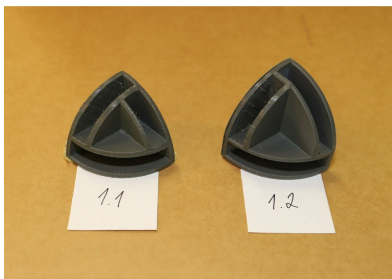
Obrázek 28: První design spojek, pravotočivá verze menší varianty (1.1), levotočivá verze větší varianty (1.2)
