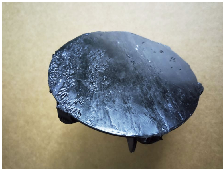
Obrázek 52: Povrch spojky, který byl při tisku v přímém kontaktu s podložkou tiskárny
