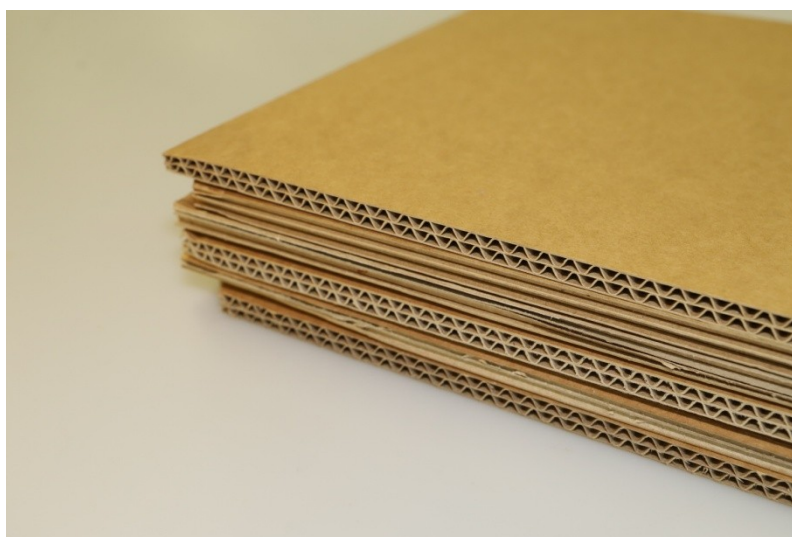
Obrázek 25: Použitá pětivrstvá lepenka
