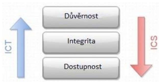
Obr. 2: Porovnání ICS a ICT ve vztahu ke kybernetické bezpečnosti. [8]
