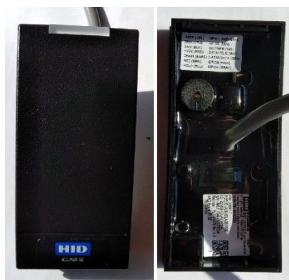
Obr. 5 – Bezkontaktní čtečka HID iCLASS SE R10, pohled z čelní a zadní strany
