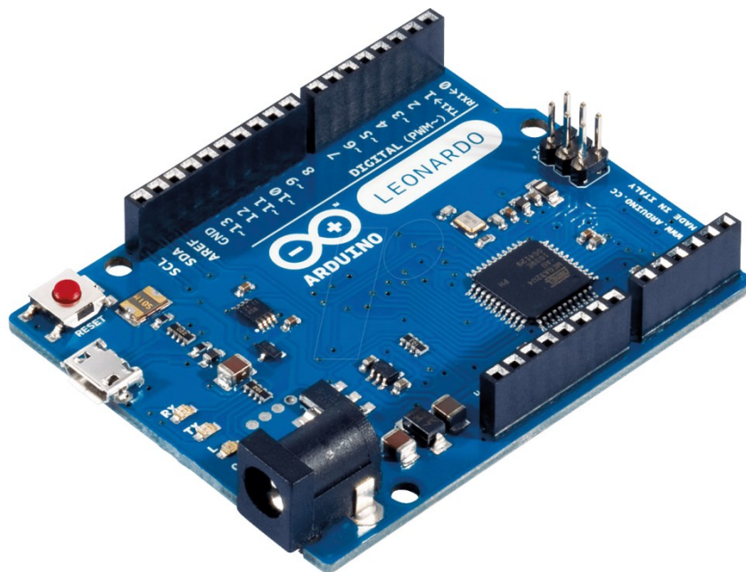
Obr. 28 Programovacia doska Arduino Leonardo
