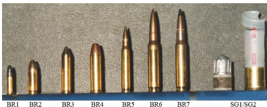
Obr. 18. Typy střeliva pro jednotlivé třídy odolnosti dle EN 1063. [32]
