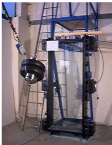
Obr. 15. Metoda zkoušení nárazem dle ČSN EN 12600. [32]
