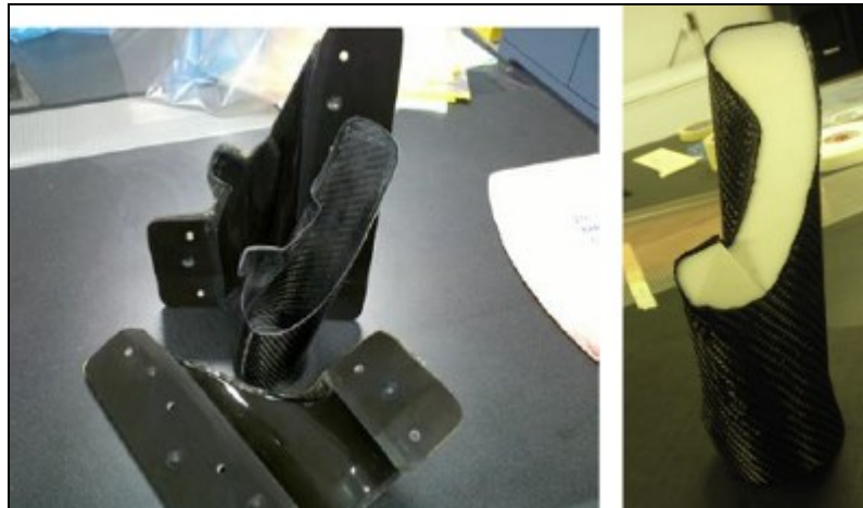
Obr. 6. Porovnání dvoudílné formy a rozpustného jádra. [6]
