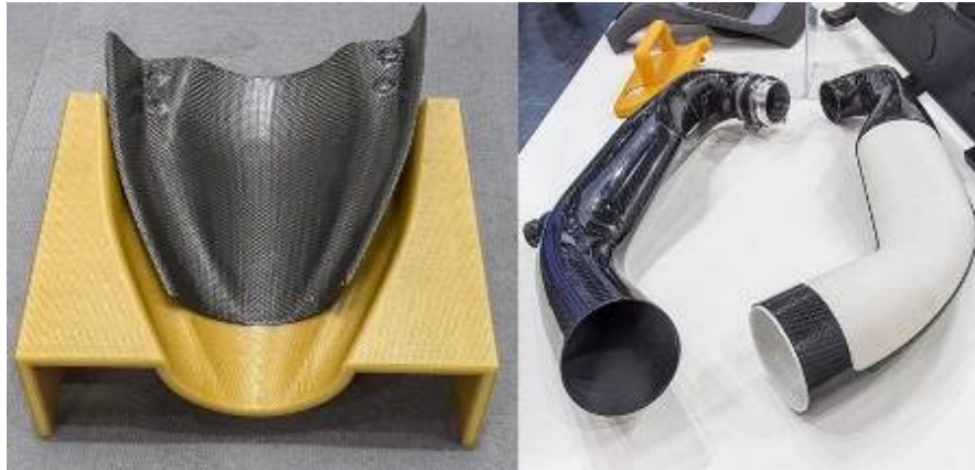
Obr. 4. Forma (na levé straně) a rozpustné jádro (na pravé straně) vyrobené 3D tiskem [7]
