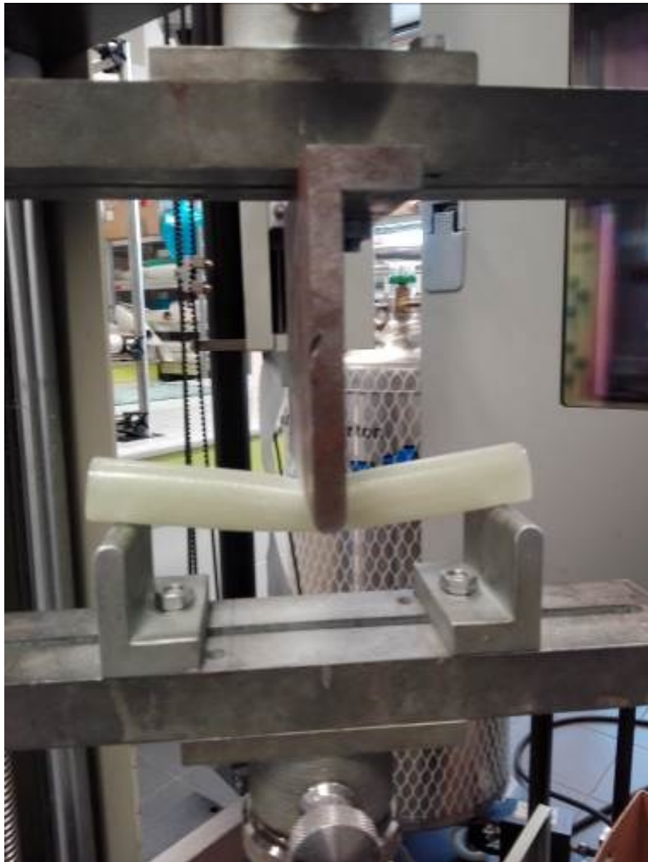
Obr. 73. Vzorek Typ 2. – vačka při zkoušce.
