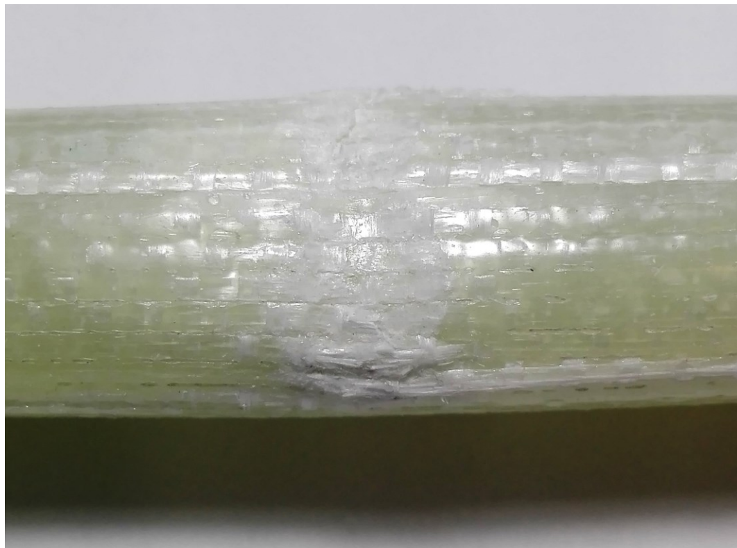
Obr. 67. Vzorek Typ 1. – vačka detail porušení.
