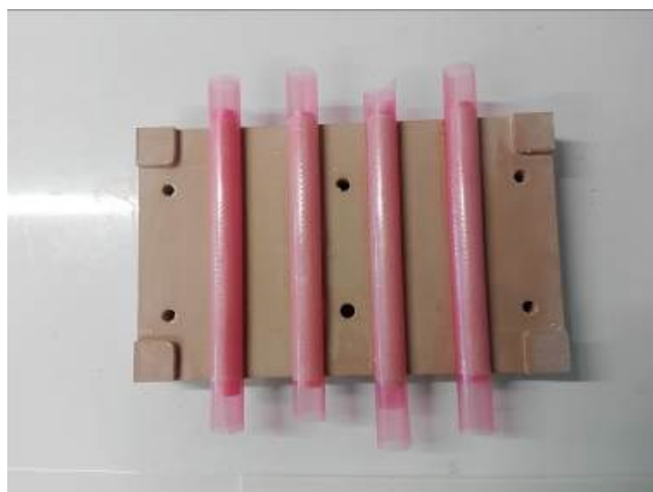
Obr. 49. Zkušební tělesa Typ 1. při ukládání do forem.
