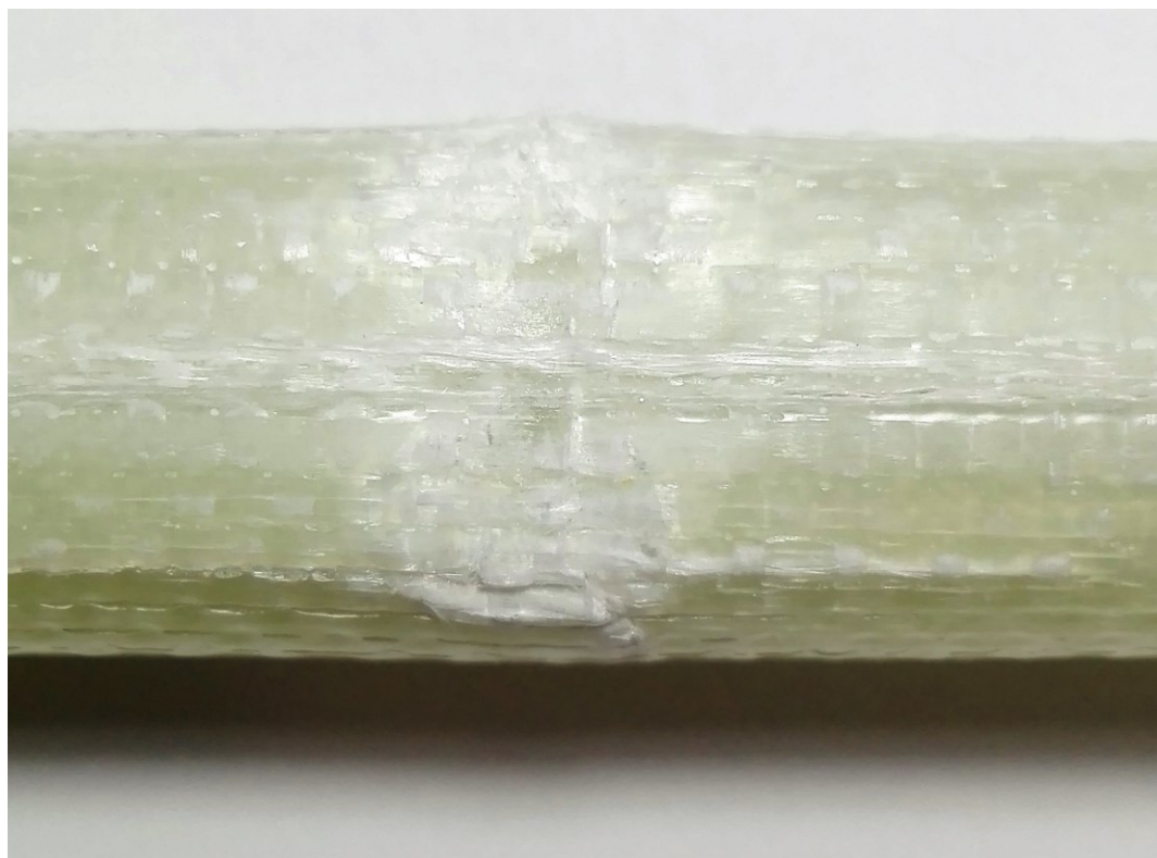
Obr. 75. Vzorek Typ 2. – vačka detail porušení.
