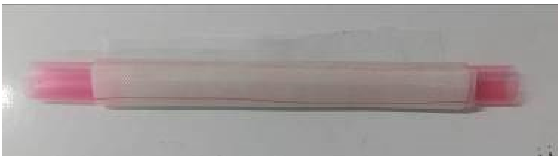
Obr. 54. Jádro vzorku Typ 2. se strhávací tkaninou připravené k zabalení do separační fólie.
