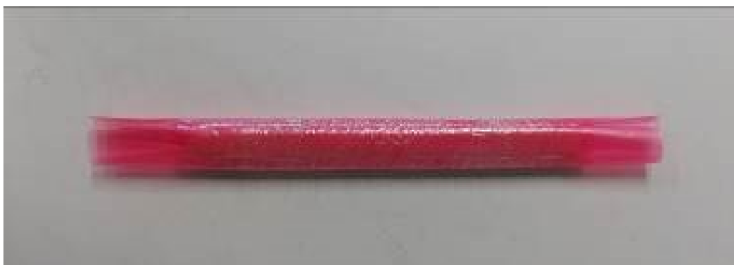
Obr. 53. Jádro vzorku Typ 2. připravené k vytvrzení (bez použití strhávací tkaniny).
