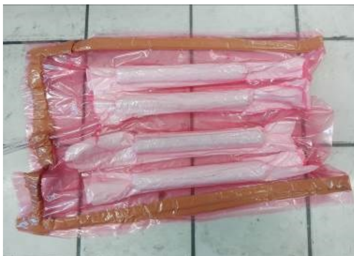
Obr. 44. Zkušební vzorky během působení vakua.
