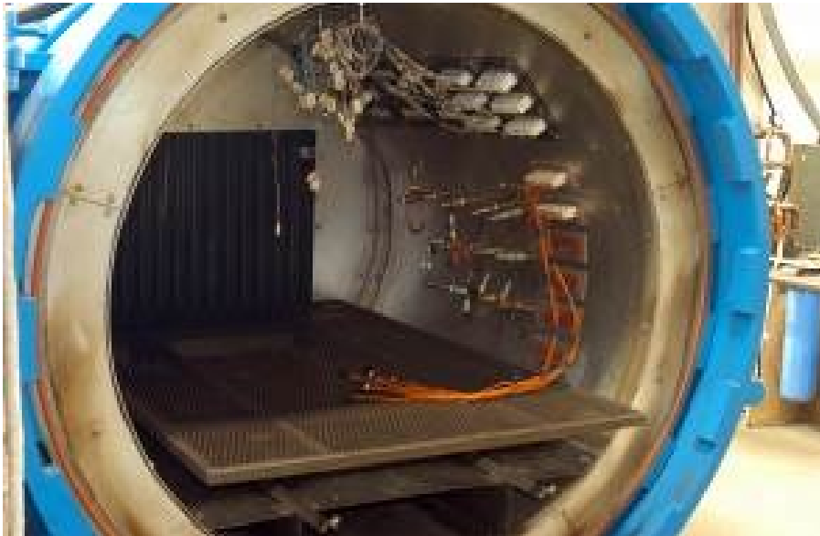
Obr. 22. Vytvrzování v autoklávu. [15]
