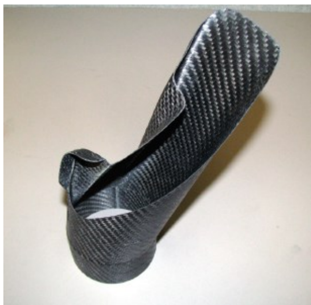
Obr. 19. Kompozitní díl po odstranění jádra. [10]
