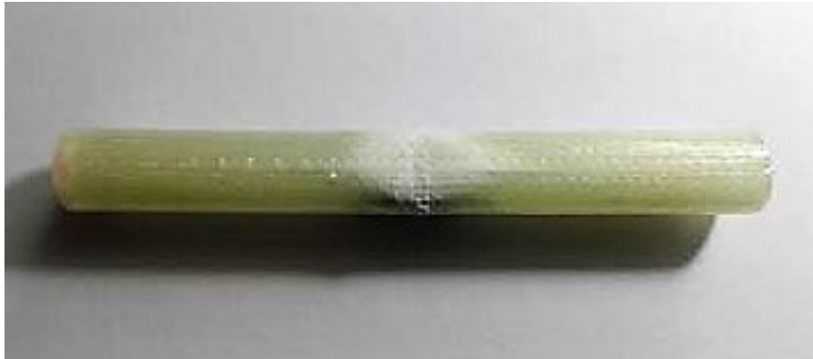
Obr. 62. Vzorek Typ 1. – kruh po zkoušce.
