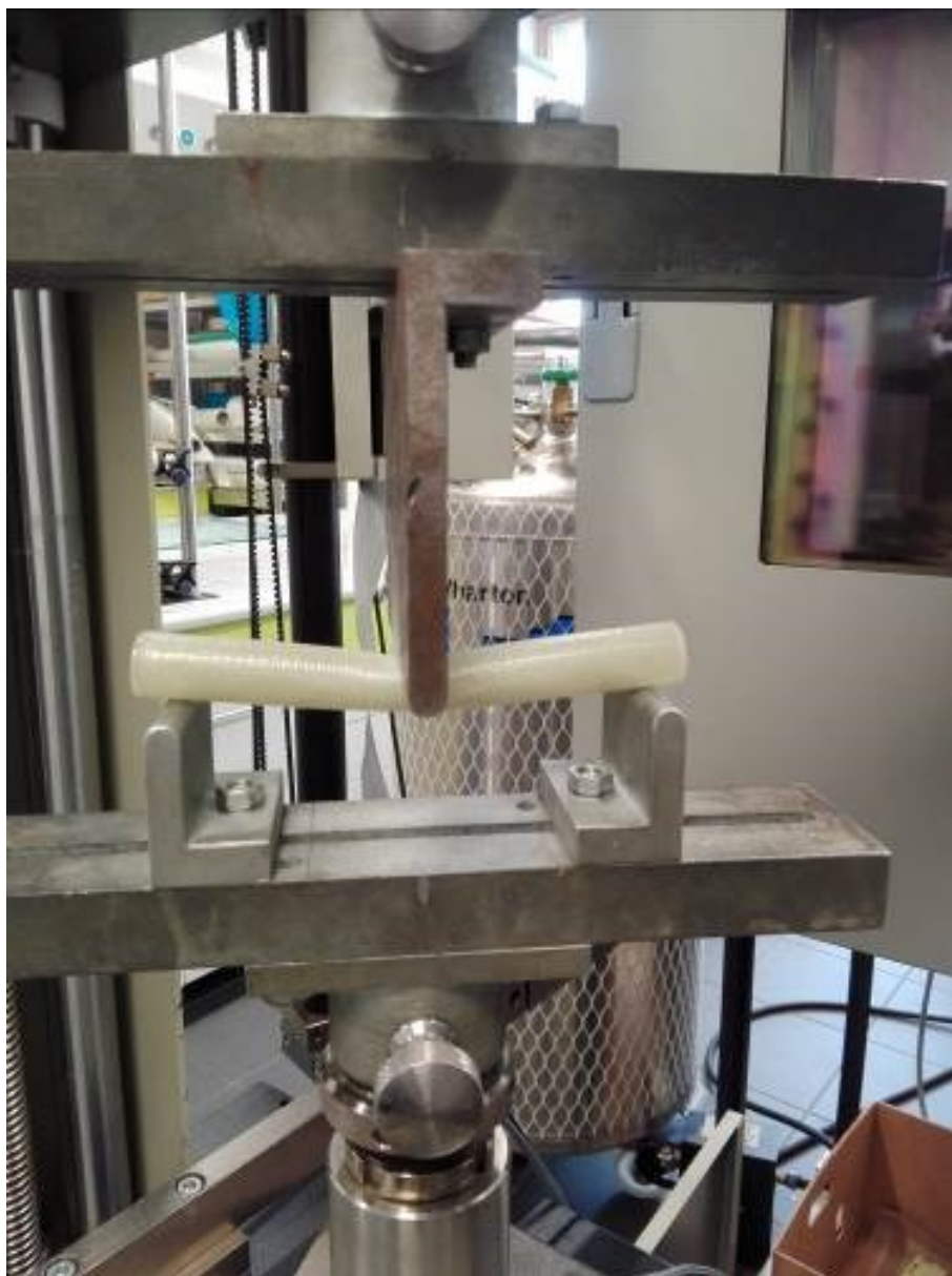
Obr. 61. Vzorek Typ 1. – kruh při zkoušce.
