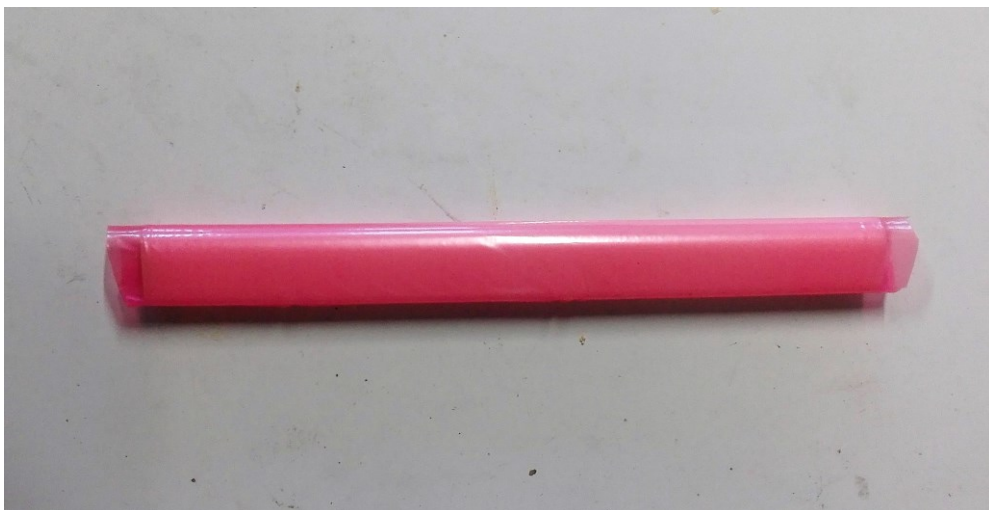
Obr. 34. Jádro obalené separační fólií.
