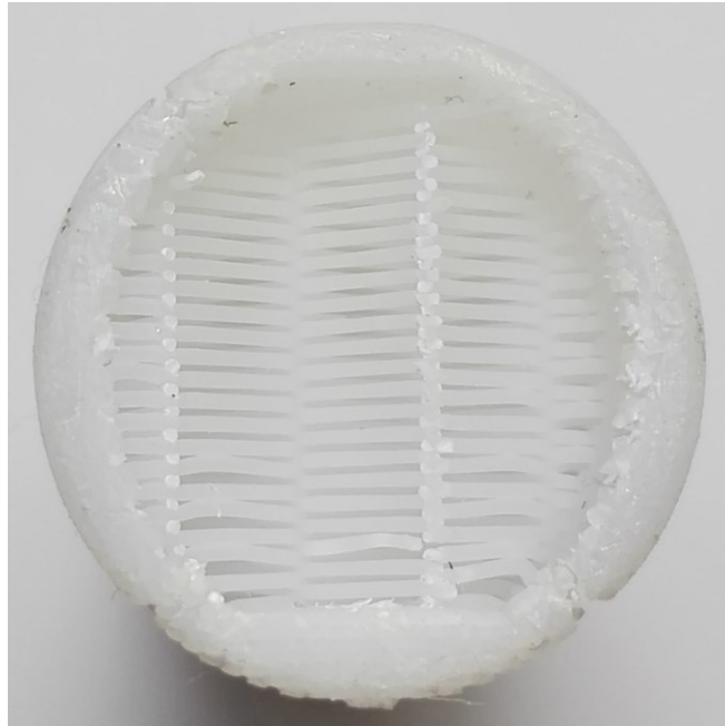
Obr. 31. Detailní pohled na řez strukturou voštiny.
