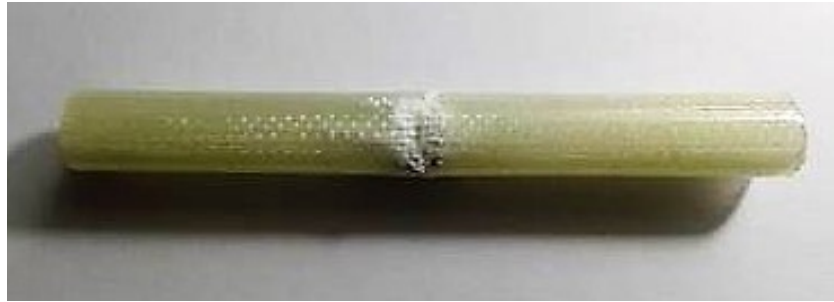
Obr. 70. Vzorek Typ 2. – kruh po zkoušce.
