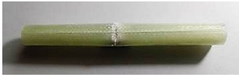
Obr. 66. Vzorek Typ 1. – vačka po zkoušce.
