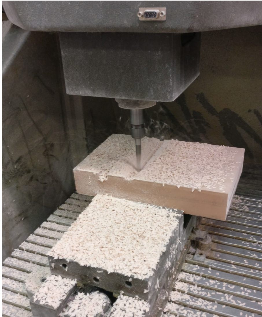
Obr. 42. Proces výroby formy na CNC stroji.
