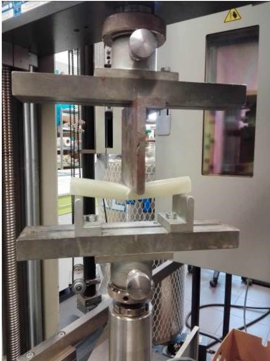
Obr. 65. Vzorek Typ 1. – vačka při zkoušce.
