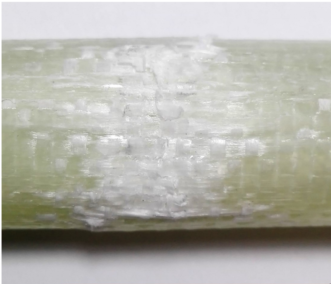
Obr. 71. Vzorek Typ 2. – kruh detail porušení.
