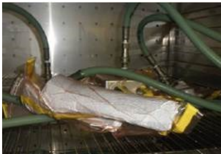
Obr. 17. Vytvrzení v autoklávu. [7]
