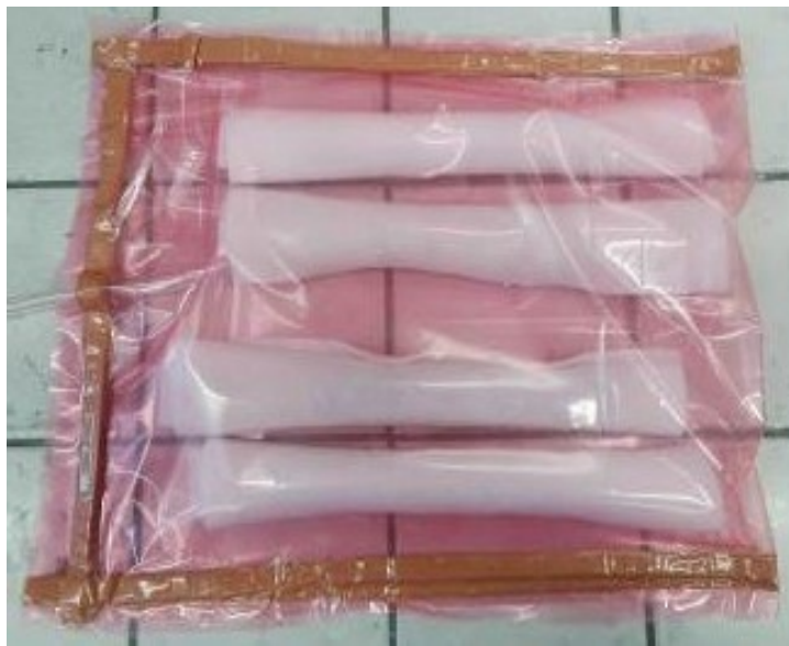
Obr. 43. Zkušební vzorky před působením vakua.
