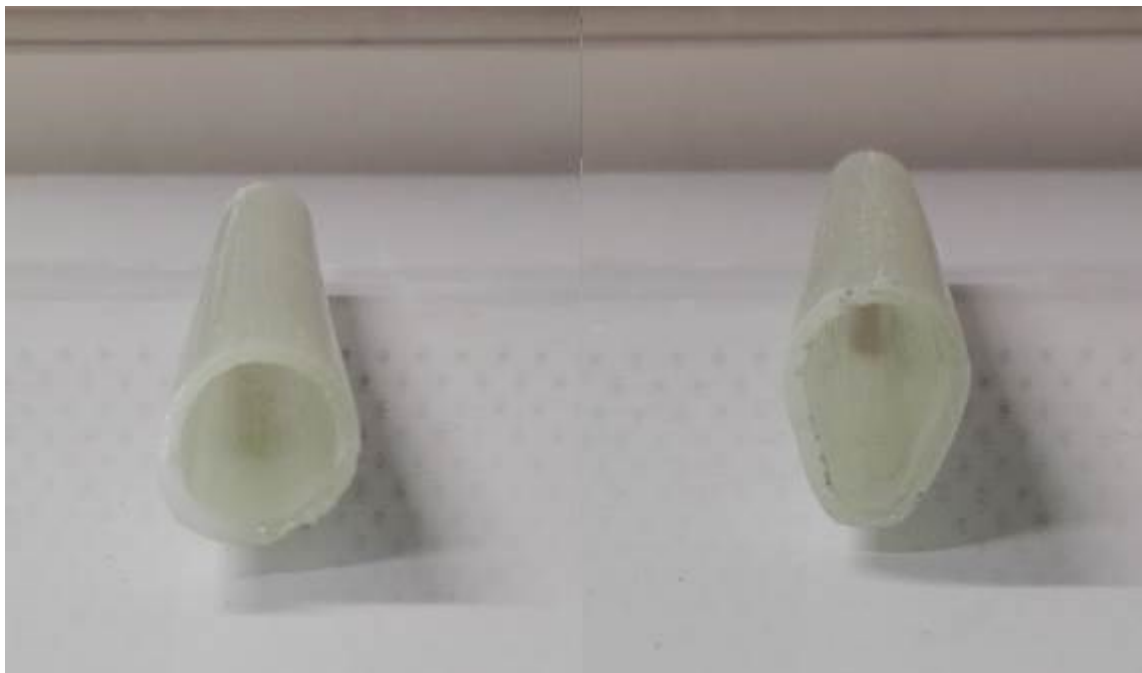
Obr. 51. Zkušební tělesa po vytvrzení (vlevo průřez kruh, vpravo průřez vačka).
