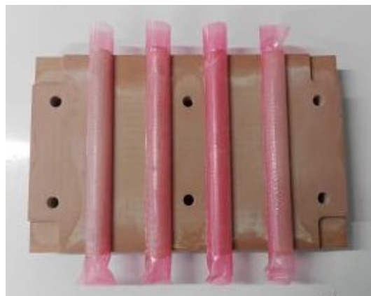
Obr. 58. Forma se vzorky po vytvrzení.
