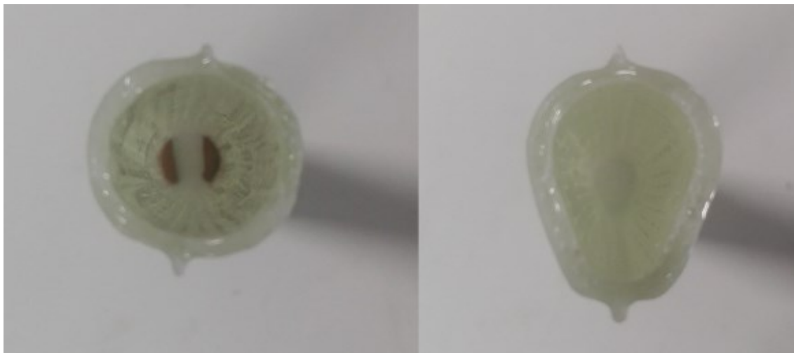
Obr. 56. Hotové nezačištěné vzorky Typ 2. po vytvrzení (vlevo průřez kruh, vpravo vačka).
