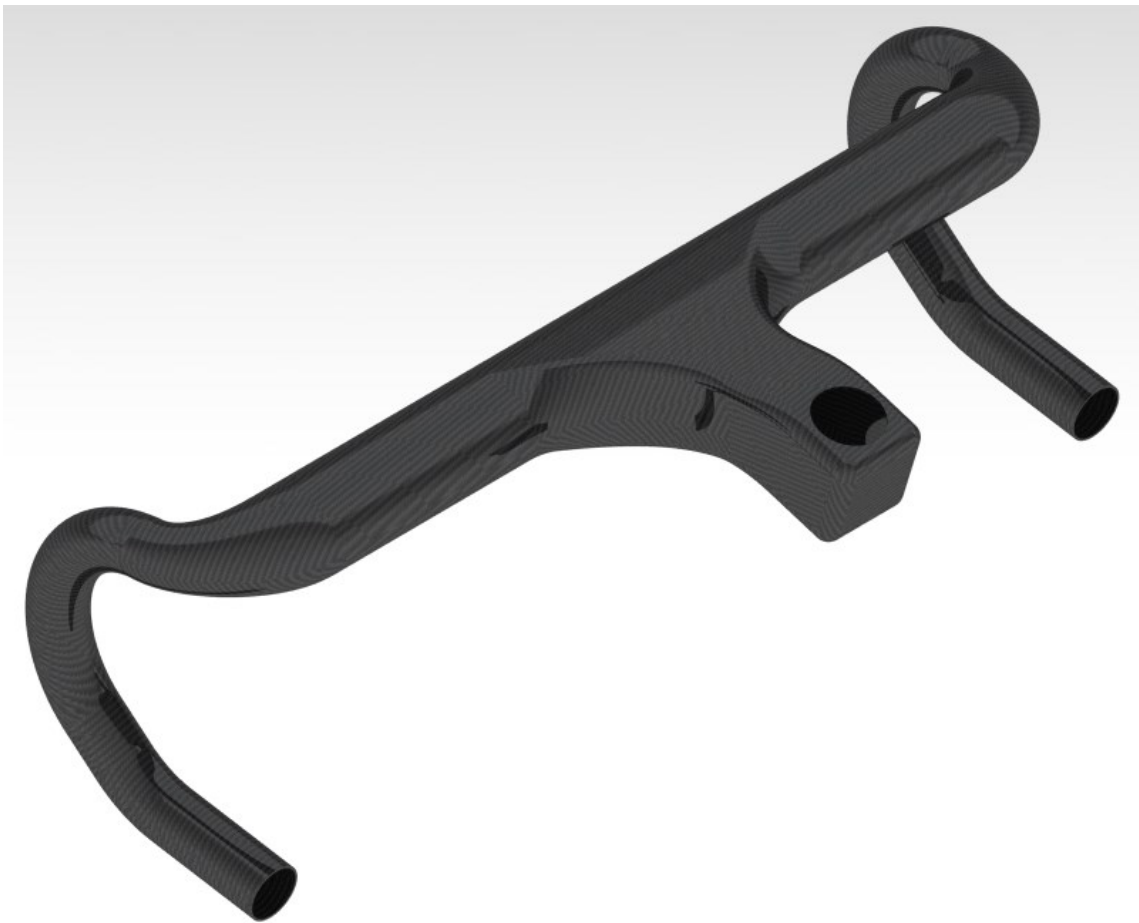
Obr. 87. Návrh kompozitních řídítek z uhlíkových vláken pro silniční kolo.
