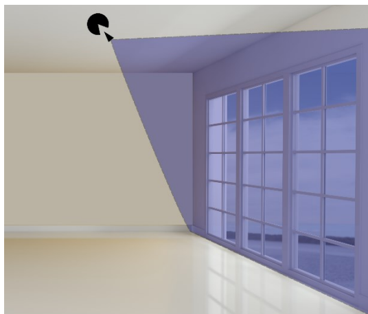
Obr. 13 Instalace detektoru na strop [16, upravil Mlčoch 2017]
