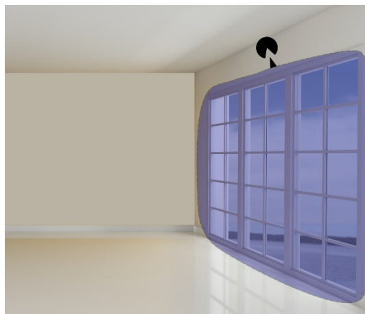
Obr. 14 Instalace detektoru nad skleněnou plochu [16, upravil Mlčoch 2017]
