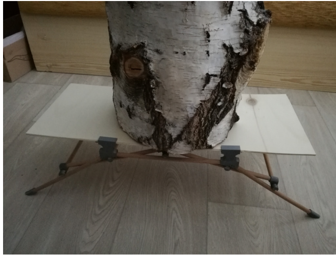
Obr. č. 21, Závažový test modelu 1:2
