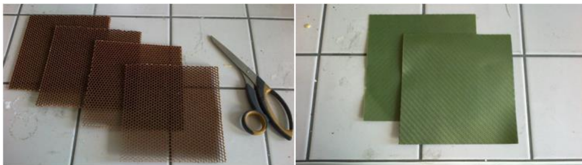
Obr. 41: Nastrihané voštiny a prepregy na požadované rozmery
