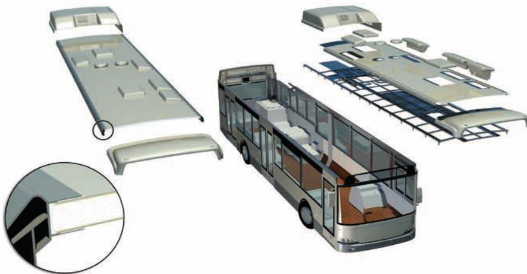
Obr. 25: Strecha autobusu vyrobená z sendvičových voštinových panelov [4]
