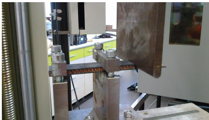
Obr. 48: Skúšobné teleso vložené v podperách
