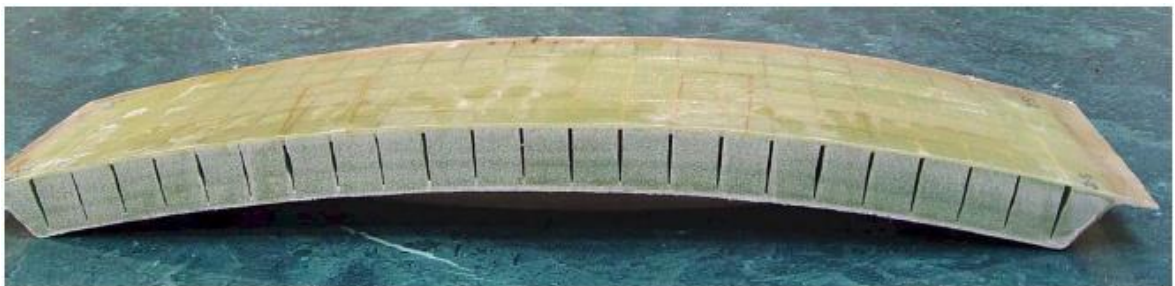
Obr. 22: Príklad zakriveného sendviču s jadrom s polymérnej peny
