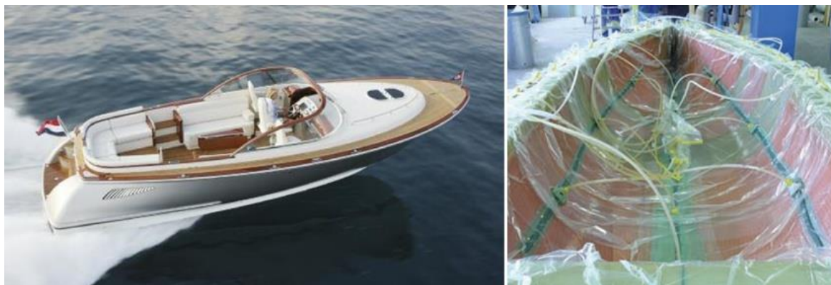
Obr. 27: Ukážka výroby člnu zo sendvičových voštinových štruktúr [4]
