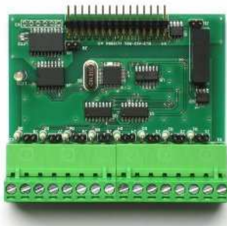
Obr. 10 Modul 16-bitových analogových vstupů s galvanickým oddělením
