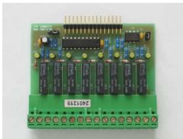
Obr. 11 Modul digitálních výstupů s relé
