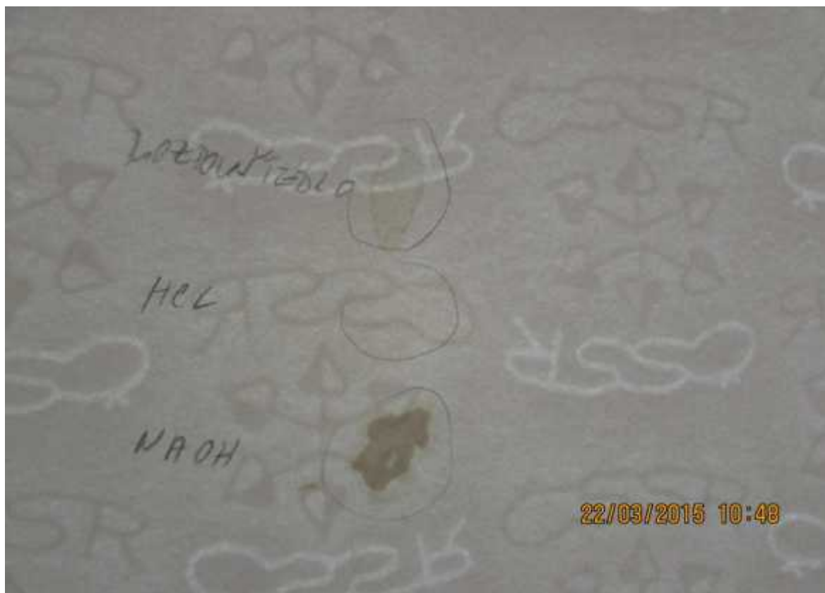
Obr. 24 Vzorek papíru firmy Neograph po aplikaci chemikálií
