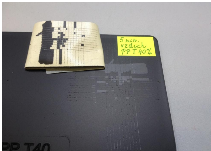
Obr. 59. Mřížková zk. PP T 40% plaz. 5 min vzduch.
