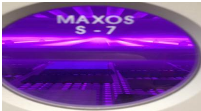
Obr. 21. Probíhající povrchová úprava v plazmové komoře.
