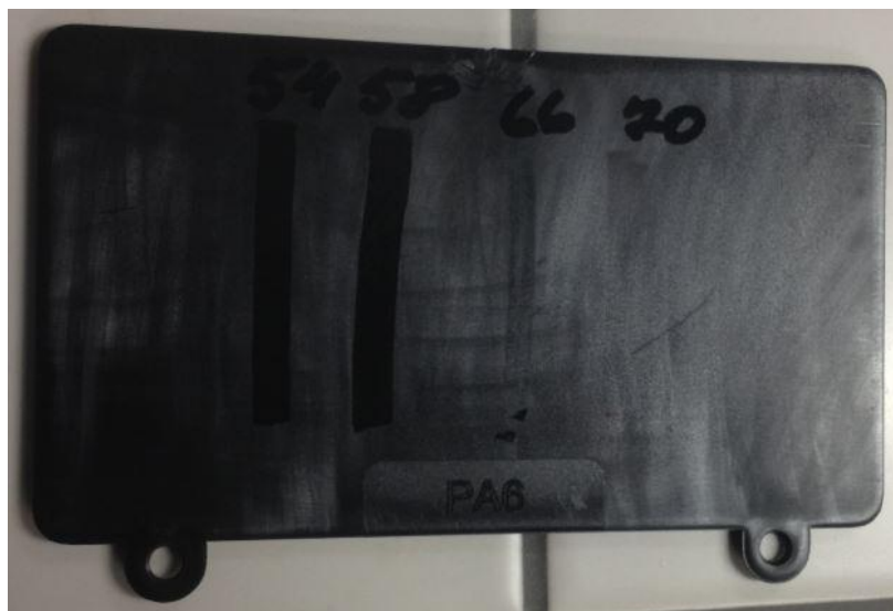
Obr. 25. Měření povrchové energie pomocí fix.
