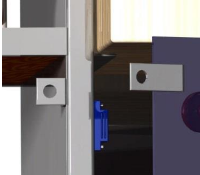
Obr. 31 Detail zámku, držáku dvířek a uložení šuplíku
