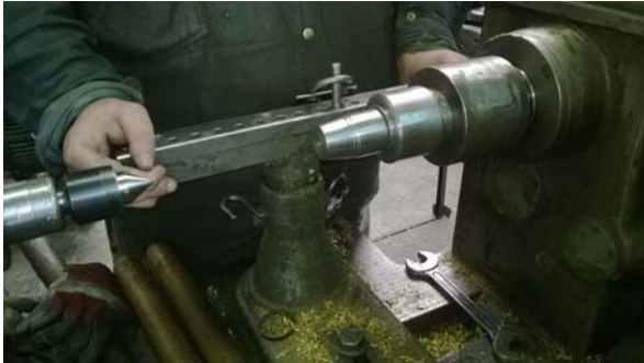
Obr. 39 Kovotlačitelský soustruh s tvarovou formou
