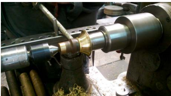
Obr. 41 Ruční tvarování mosazného plechu
