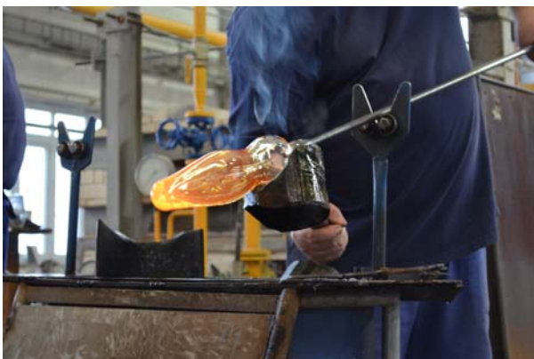
Obr. 34 Tvarování perle před vložením do formy
