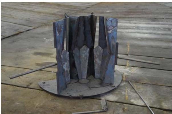
Obr. 30 Kovová forma otevřená
