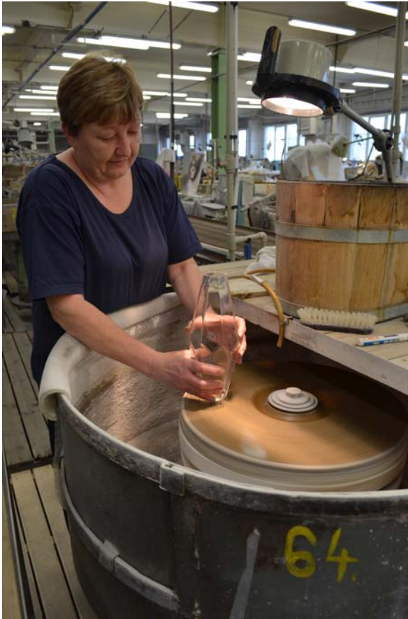
Obr. 37 Broušení horní a dolní plošky
