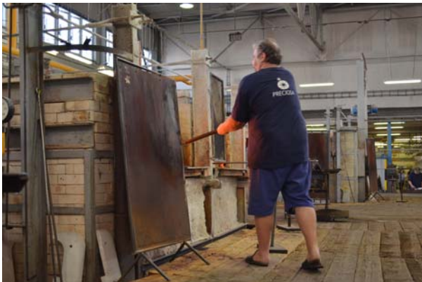
Obr. 31 Nabírání skloviny na sklářskou píšťalu
