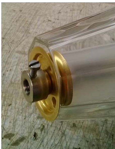
Obr. 46 Napojení vnitřní skleněné trubice
