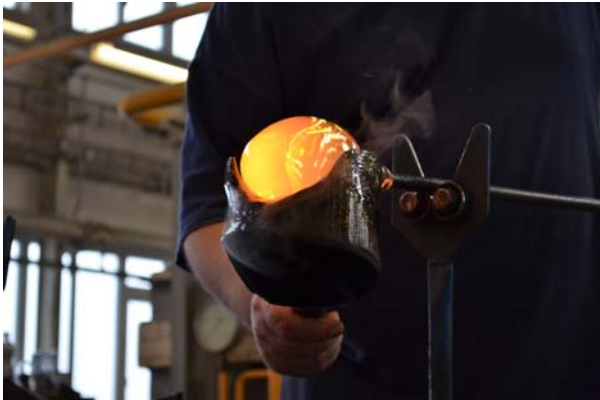
Obr. 33 Úprava skloviny ve svaláku
