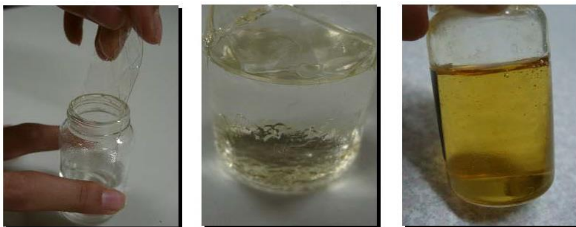
Obr. 31 Získávání formy prstu s otisky a příprava materiálu na odlitek prstu (vařící voda, v níž se rozpustí želatina) 19
