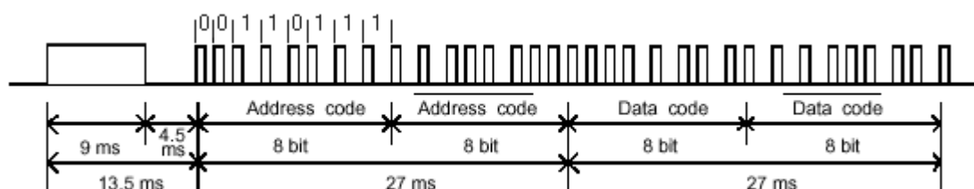
Obr. 15: datový rámeček protokolu NEC [29]
