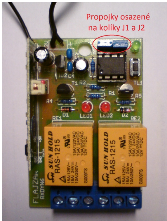
Obr. 62: přijímač (propojky osazené na kolíky J1 a J2)
