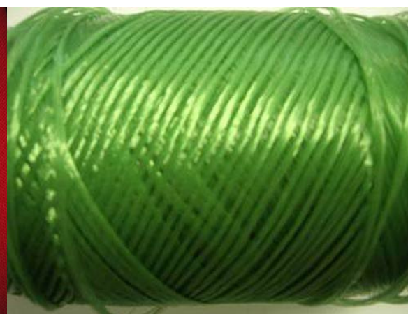
Obr.č.13, PET monofil vyrobený ve sduženém pramenu
