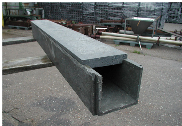
Obr. č.10, Ochranný kanál
