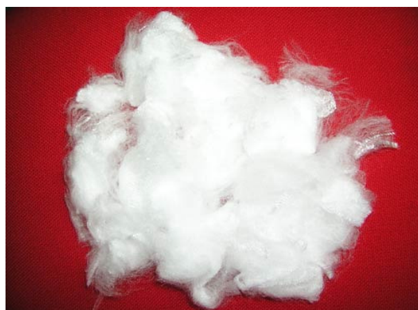
Obr.č.12, PET stříž vyrobená z recyklátu z PET
