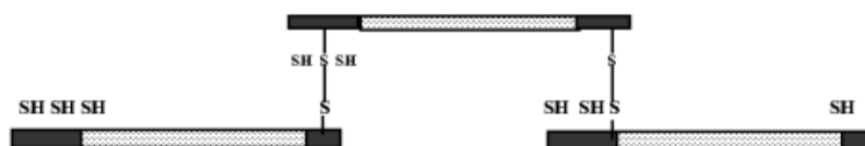
Obrázek 12 Model vzájemného příčného propojení přímých řetězců pomocí –S-S- vazeb v koncových doménách [6]
