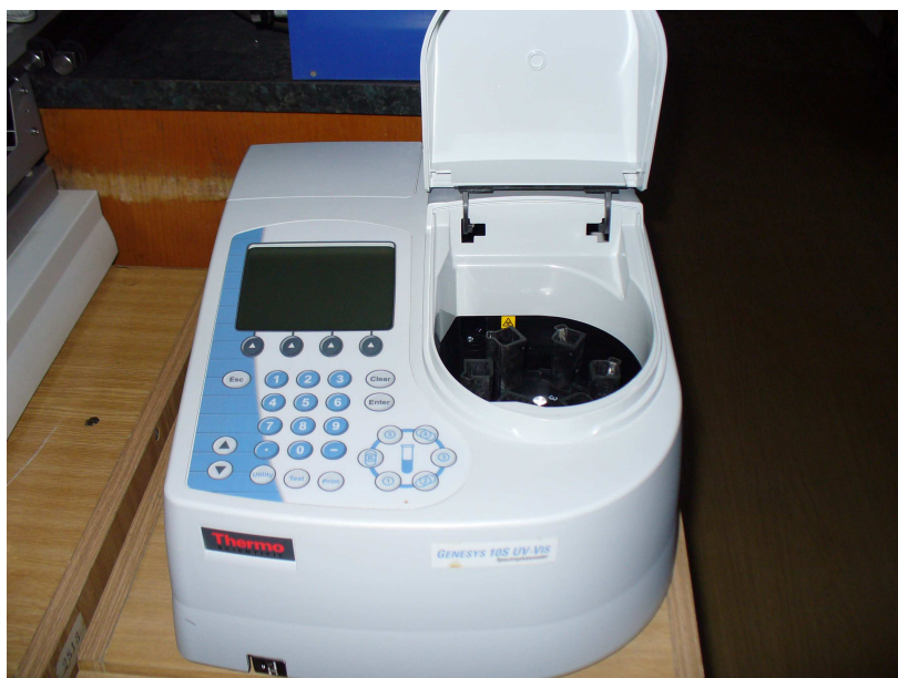
Obr. 17 Pohled do spektrofotometru na uložené kyvety se vzorky
