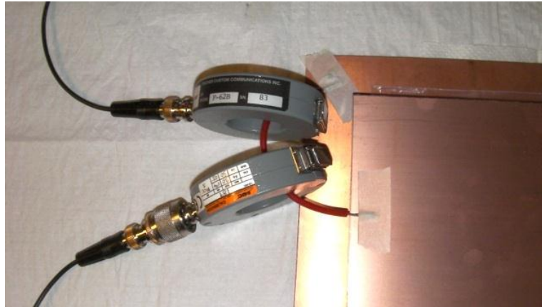
Obr. 21. Proudové sondy při měření rušivého proudu.[12]
