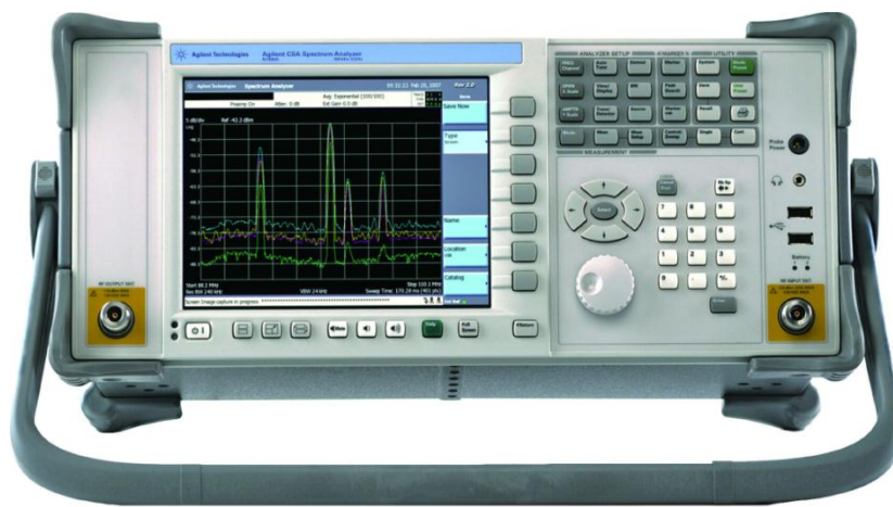
Obr. 29. Spektrální analyzátor Agilent N1996A.[15]
