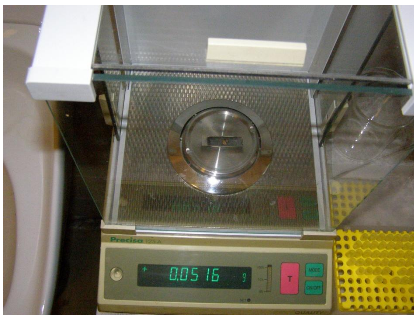
Obr. č. 16: Analytická váha PRECISA 125A s naváženým vzorkem.
