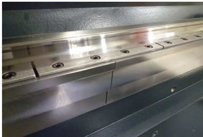
Obr. 28. Zalitý ocelový profil v polymerbetonu pro upevnění lineárního vedení
