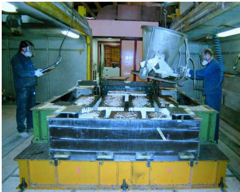
Obr. 26. Odlévání polymerbetonu z licí pánve
