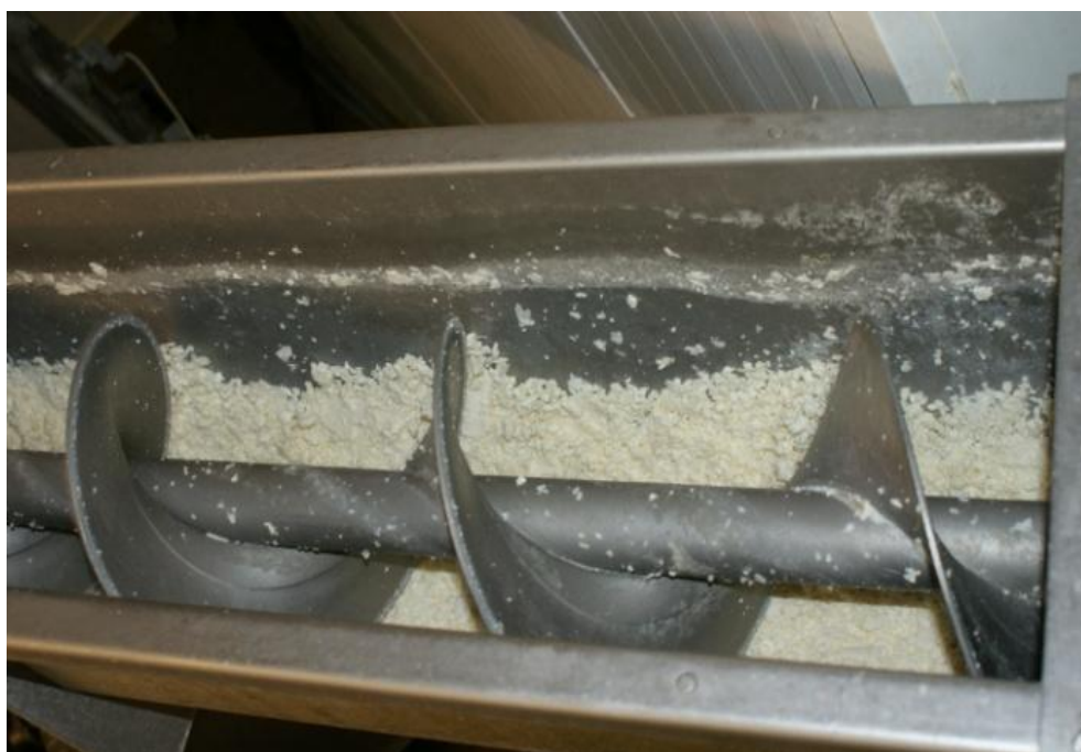
Obr. 18: Šnek dopravující rozdrcenou, odkapanou syrovátku do pařícího zařízení
