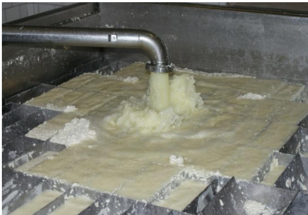
Obr. 13: Napouštění sýřeniny do lisovací vany
