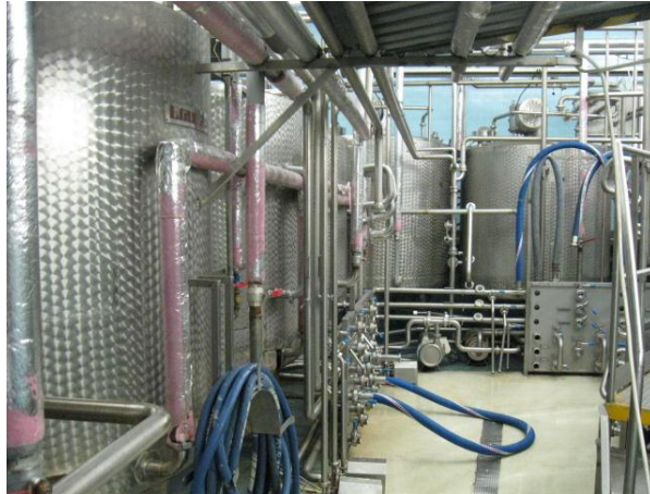
Obr 3 Zraci nádrfe na sm s pro výrobu MSK
