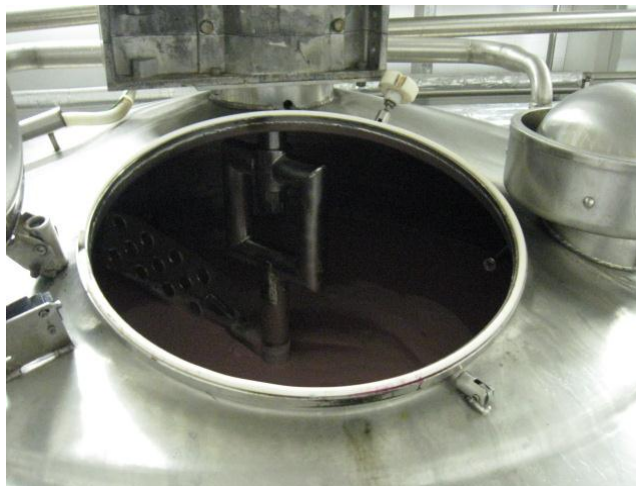
Obr 18 Náhled na míchadlo zraženého tanku.
