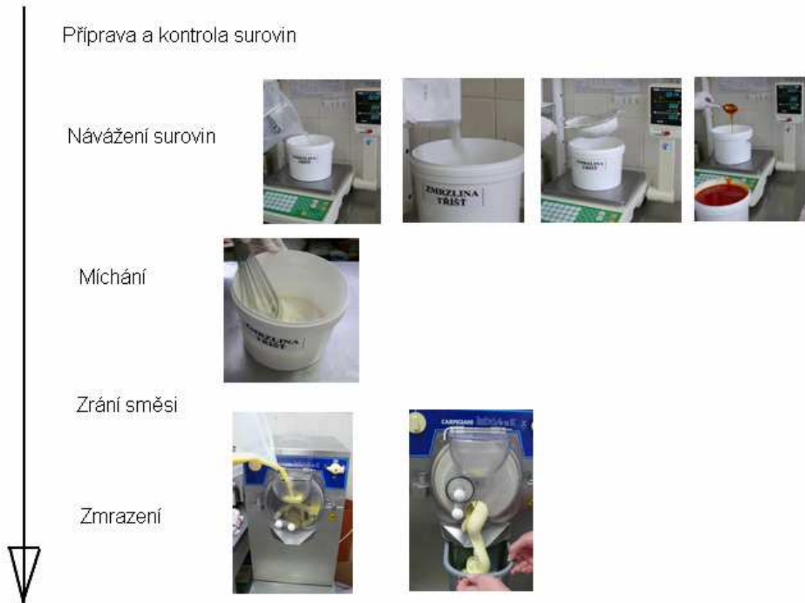
Obr. 17. Postup výroby zmrzliny neprůmyslovým způsobem
