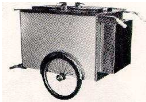
Obr. 2. Ruční dvojkolový zmrzlinový vozík (chlazeno "suchým ledem")
