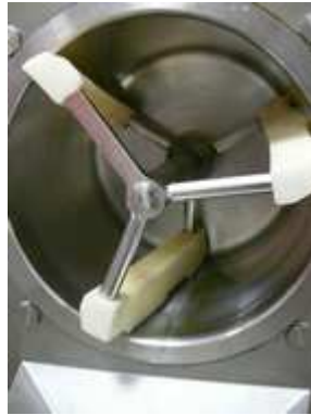
Obr. 6. Horizontálně uložený mrazící válec i s lopatkami
